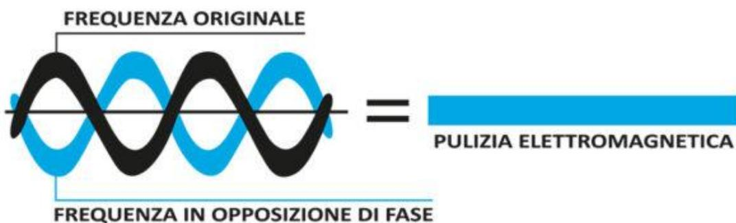
Per sfruttare questa proprietà fisica delle onde è necessario effettuare un campionamento, con una serie di microfoni dei suoni e ricreare in corrispondenza solamente a quelli che si vogliono eliminare un'onda sonora inversa capace di eliminare il rumore registrato.
