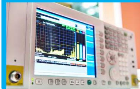
Ricevitore per la misura del campo elettromagnetico
